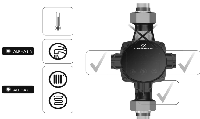
Рис. 6 Допустимое положение головной части насоса при циркуляции горячего теплоносителя
