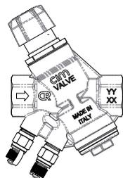
Cim 776LF - Автоматический комбинированный балансировочный клапан с измерительными ниппелями - PN 25 - "CR" Латунь
