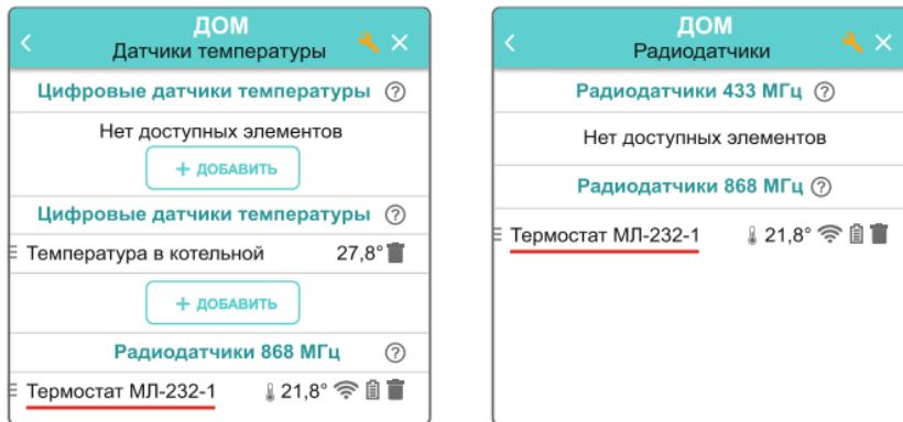
В конфигурации Контроллера ZONT Термостат применяется или как датчик температуры, по которому регулируется отопительный контур, или как источник данных для мониторинга температуры в месте его установки. Из личного кабинета сервиса ZONT пользователь может дистанционно изменить значение целевой температуры Термостата. Для этого необходимо в конфигурации Контроллера создать отдельный отопительный контур с комнатным термостатом МЛ-332 в качестве датчика температуры.
