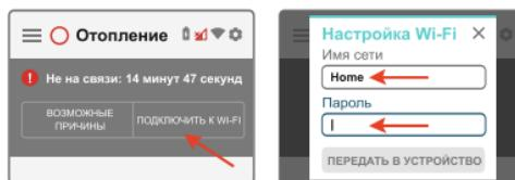
**Примечание:** Роутер должен быть настроен на работу в диапазоне 2,4 ГГц и раздавать интернет в режиме "router" (режимы "мост"/"bridge" непригодны). Функция беспроводного Wi-Fi не поддерживается. В настройках роутера должен быть выбран код шифрования WPA2 и использование 2G BGN Tkip AES или без защиты.
