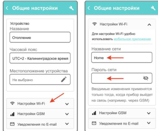
В приложении нажать кнопку «Подключить к WI-FI» и в окне «Настройка WI-FI» указать имя и пароль сети. Выключить и включить основное и резервное питание Контроллера и нажать кнопку «Передать в устройство». В течение 2-х минут с момента включения Контроллер будет осуществлять поиск и подключение к указанной в настройке сети Wi-Fi.
