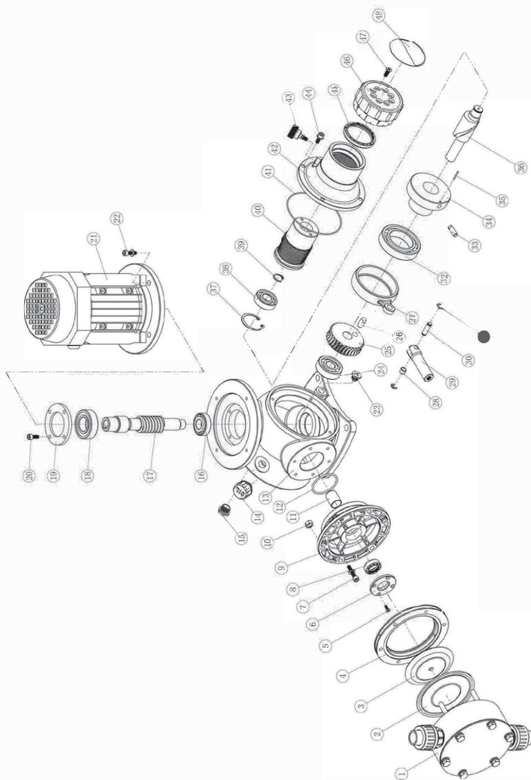
**Рис. 23** Перечень деталей насоса GM
