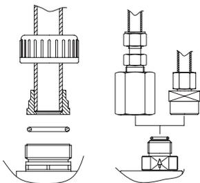
Рис. 13 Подсоединение трубопроводов
