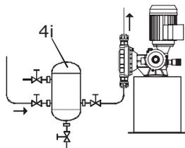
**Рис. 7** Установка демпфера пульсаций на линии всасывания
