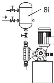
**Рис. 8** Установка демпфера давления на линии нагнетания
