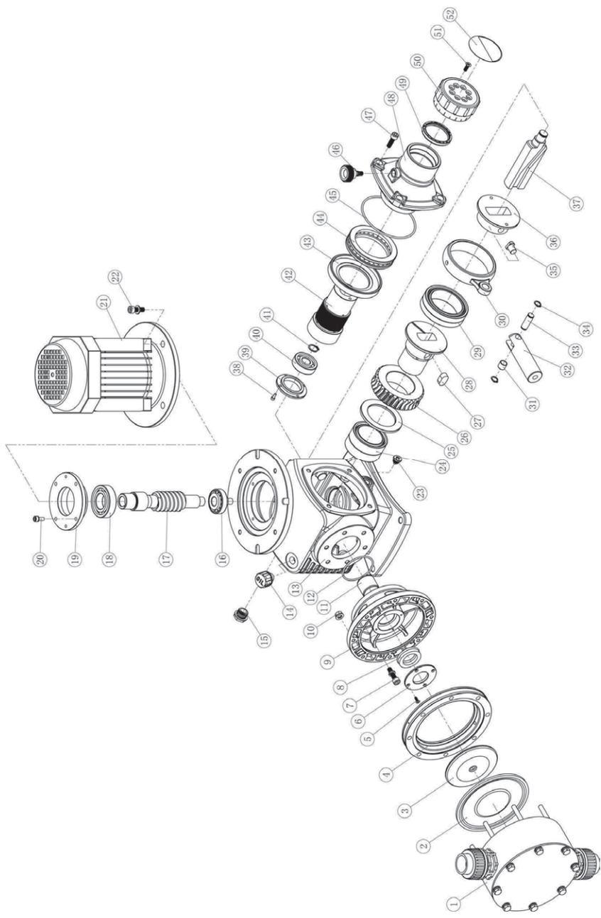
**Рис. 24** Перечень деталей насоса GB
