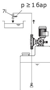
**Рис. 10** Установка с клапаном поддержания давления
