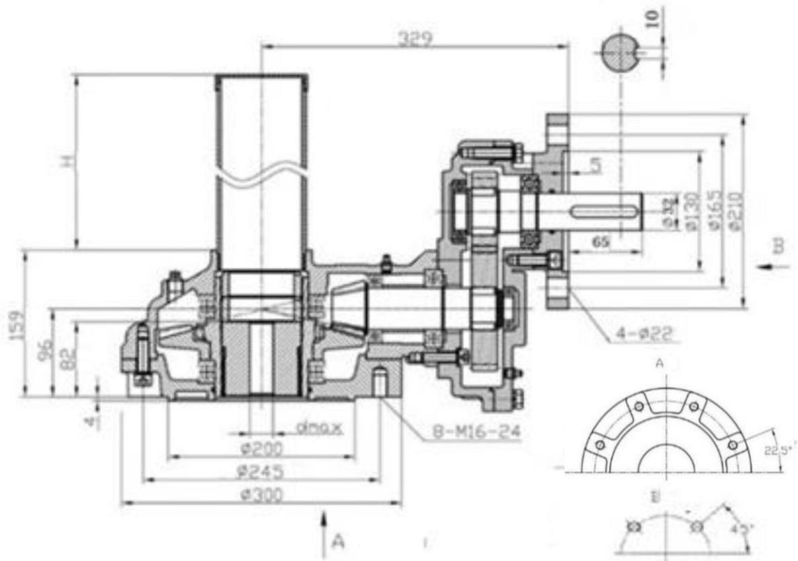
Д) Устройство присоединительного фланца задвижки Ду700, Ду800 под редуктор.
