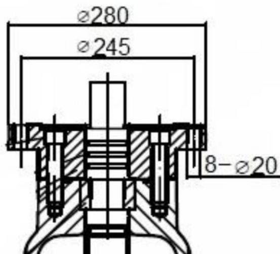
**Таблица №2. Габаритные и присоединительные размеры задвижек в мм.**
